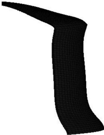
图 10 工况 3 罐壁的变形图
