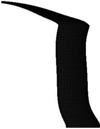
图 9 工况 2 罐壁的变形图
